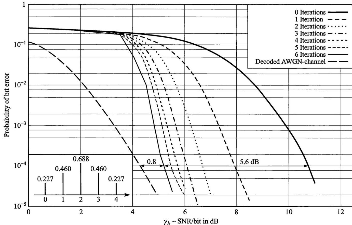
Для данного примера использовался рекурсивный систематический кодер со скоростью  $1/2$  и длиной кодового ограничения  $K = 5$ . Размер блока псевдослучайного перемежителя – 4096 бит. Сигналы – двоичные противоположные.
