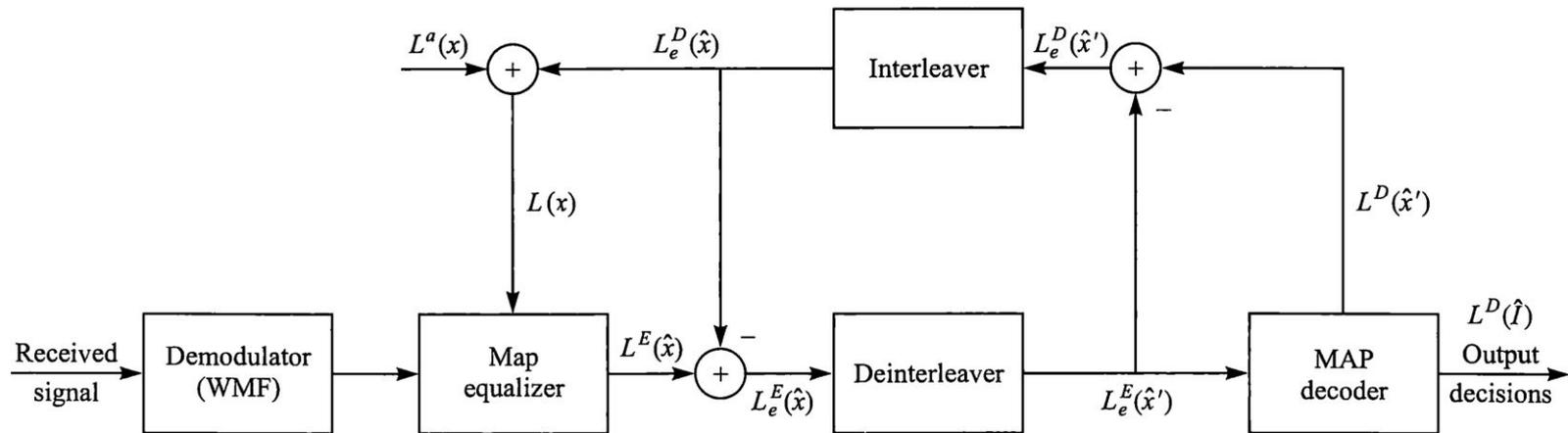
После одного такта работы каждого SISO-блока вычисляется внешняя информация (extrinsic) для передачи по петле турбо эквалайзера.
