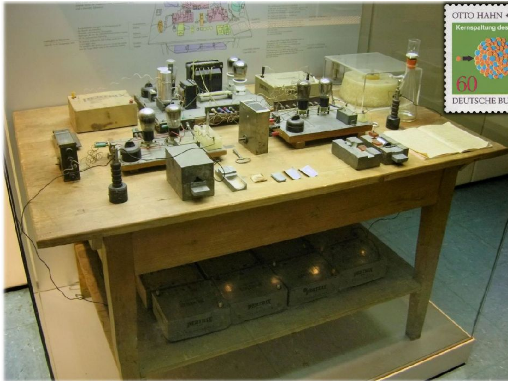
Модель экспериментальной установки, на которой Отто Ган и Фриц Штрассман открыли деление ядра урана в 1938 году.
