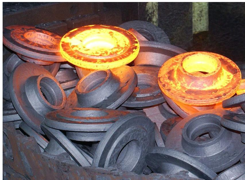
Горячая объемная штамповка является одним из основных видов обработки металлов давлением (ОМД), которым изготавливают заготовки для ответственных деталей автомобилей, тракторов и пр.
