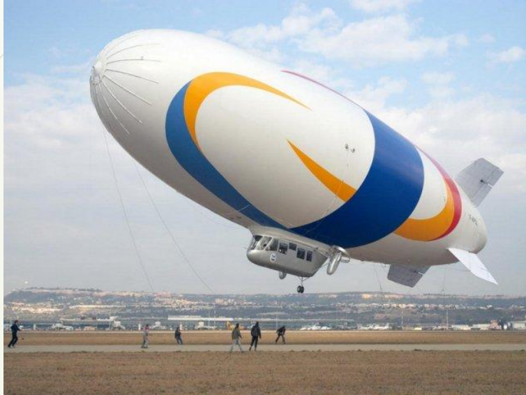
Рис. 5 Дирижабль, оболочка которого наполнена гелием
