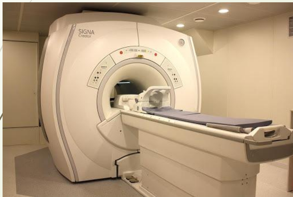
Рис. 4 Аппарат для проведения магнитно-резонансной томографии, в котором гелий используется для охлаждения электромагнитов
