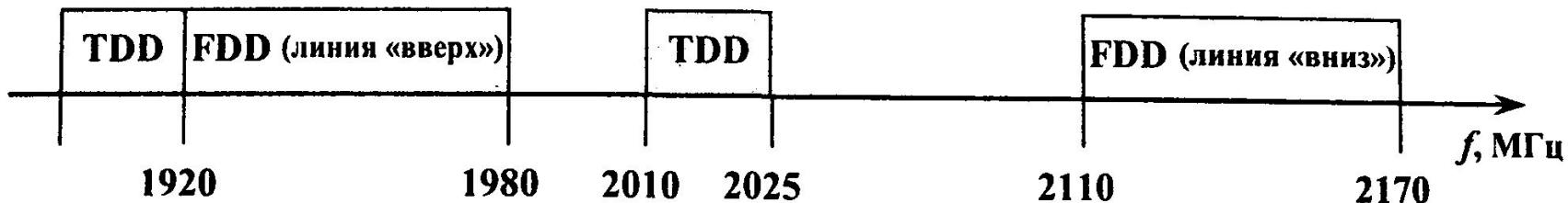
Появление этих двух технологий радиодоступа, FDD и TDD, привело в итоге к разработке оборудования, способного поддерживать оба режима, обеспечивать их взаимодействие и использовать различные принципы управления радиочастотным ресурсом.
