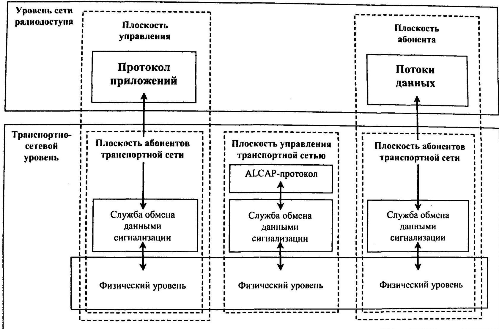
Взаимодействие различных подсистем UMTS в вертикальных плоскостях (Plane) осуществляется на основе сетевых протоколов, а на горизонтальных уровнях (Layer) – на основе как протоколов, так и интерфейсов. При разработке модели UMTS был соблюден принцип логической независимости различных уровней и плоскостей управления, позволяющий изменять структуру одних протоколов без изменения других.
