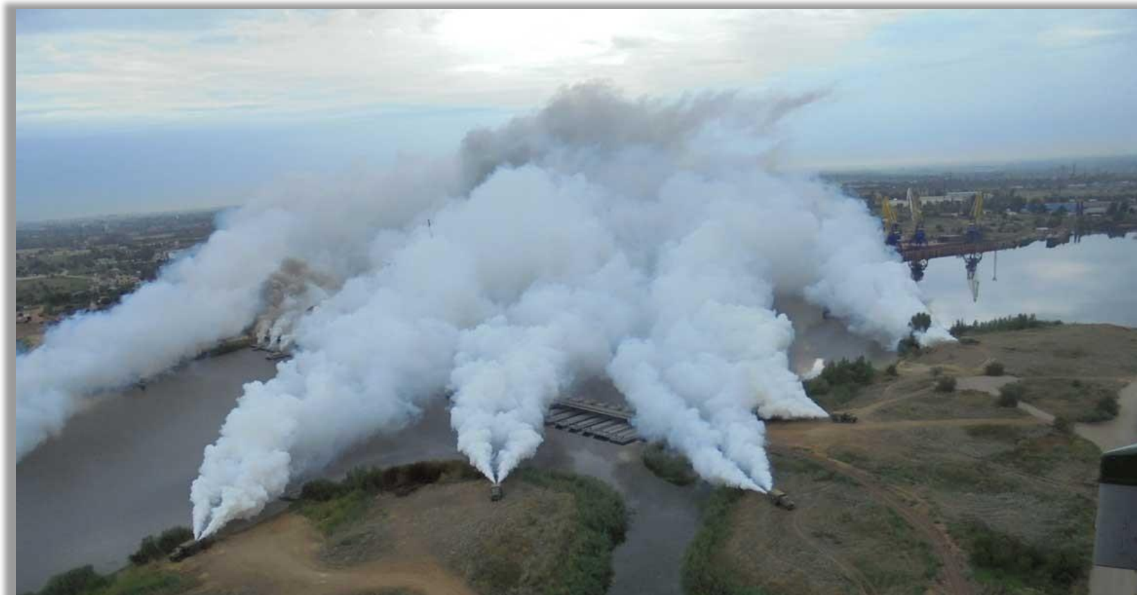
Маскировка аэрозолями мостовой переправы
