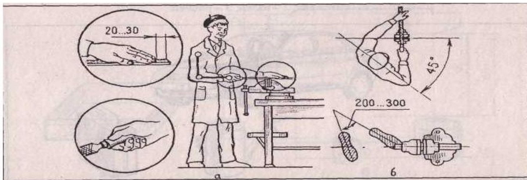
Рис. 46. Организация работы около слесарного верстака: а – подбор высоты верстака; б – положение рук и ног при работе
