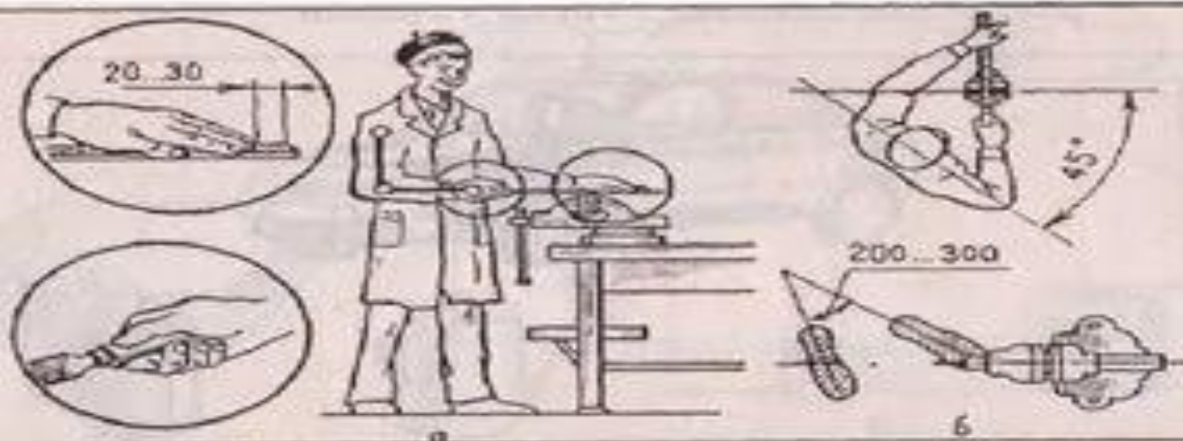
Рис. 46. Организация работы около слесарного верстака: а – подбор высоты верстака; б – положение рук и ног при работе
