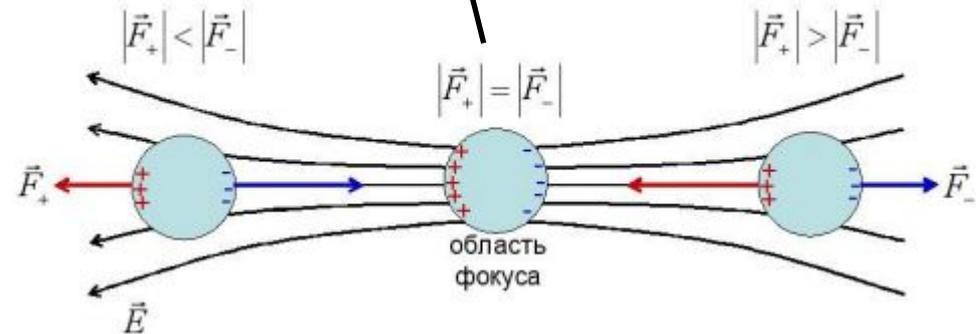
Оптический пинцет позволяет передвигать и/или удерживать частички (10 нм до 10 мкм). Принцип прост – всё притягивается к фокусу.
