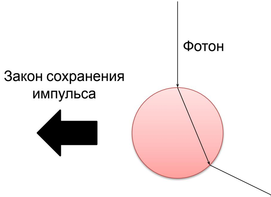
Оптический пинцет позволяет передвигать и/или удерживать частички (10 нм до 10 мкм). Принцип прост – всё притягивается к фокусу.
