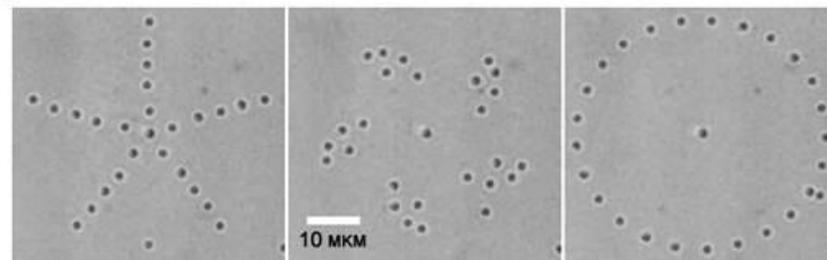
Оптический пинцет позволяет передвигать и/или удерживать частички (10 нм до 10 мкм). Принцип прост – всё притягивается к фокусу.
