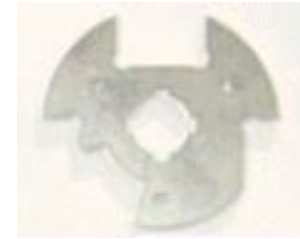
4. Резка нерж. стали SUS304 2мм
