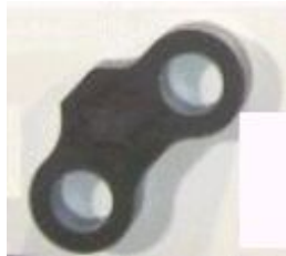
2. Резка толстой пластины SS400 16мм
