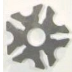
3. Резка алюминия AL5052 6мм
