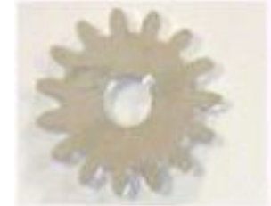
5. Резка нерж. стали SUS304 6мм
