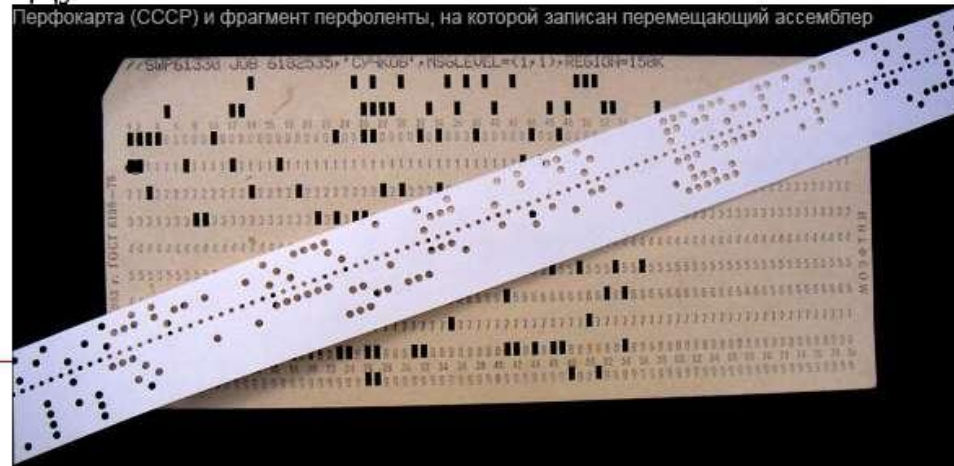
Перфокарта (СССР) и фрагмент перфоленты, на которой записан перемещающий ассемблер
