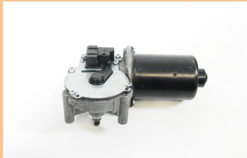
Моторчик стеклоочистителей имеет базовую конструкцию независимо от модели автомобиля. К основным элементам можно отнести непосредственно сам электродвигатель и редуктор (как правило, червячный), который увеличивает усилие от электродвигателя в несколько раз. Современные устройства могут быть оборудованы дополнительными элементами, включая предохранители для защиты от сильных нагрузок, подогревательные элементы для работы при низких температурах и многое другое.
