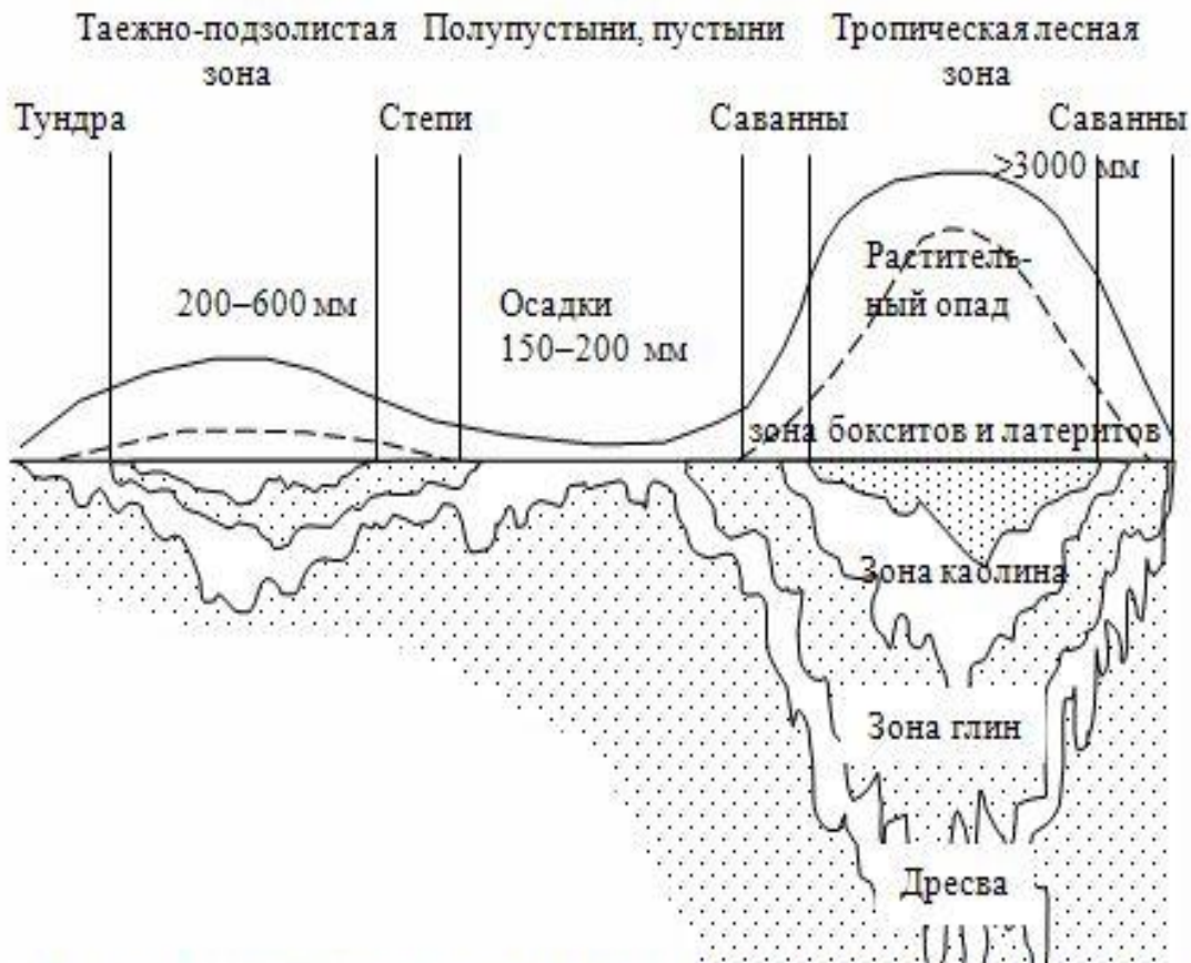
Рис. 21. Строение коры выветривания в различных климатических зонах (А. Г. Булах, 1999)
