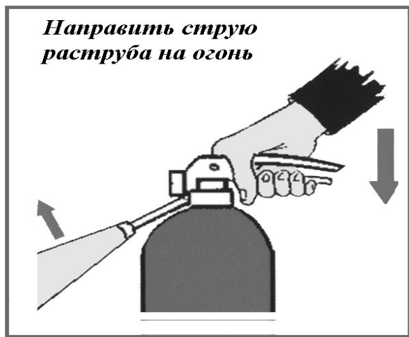
Рис. 8. Приведение в действие ручного углекислотного огнетушителя (плакат)
