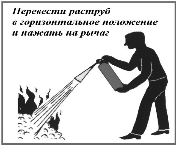
Рис. 8. Приведение в действие ручного углекислотного огнетушителя (плакат)
