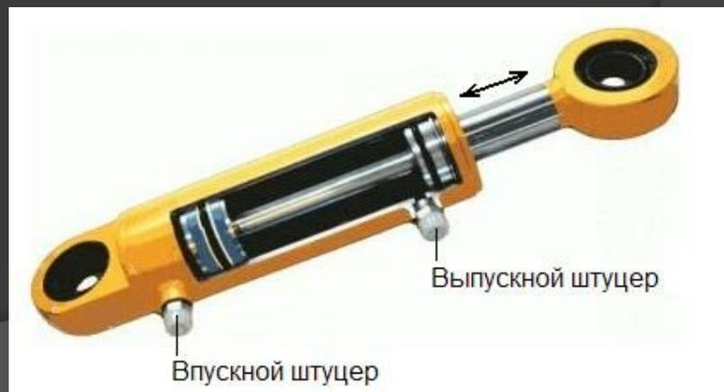
3. После этого рабочая жидкость по гидролиниям возвращается либо в **бак**, либо непосредственно к насосу
