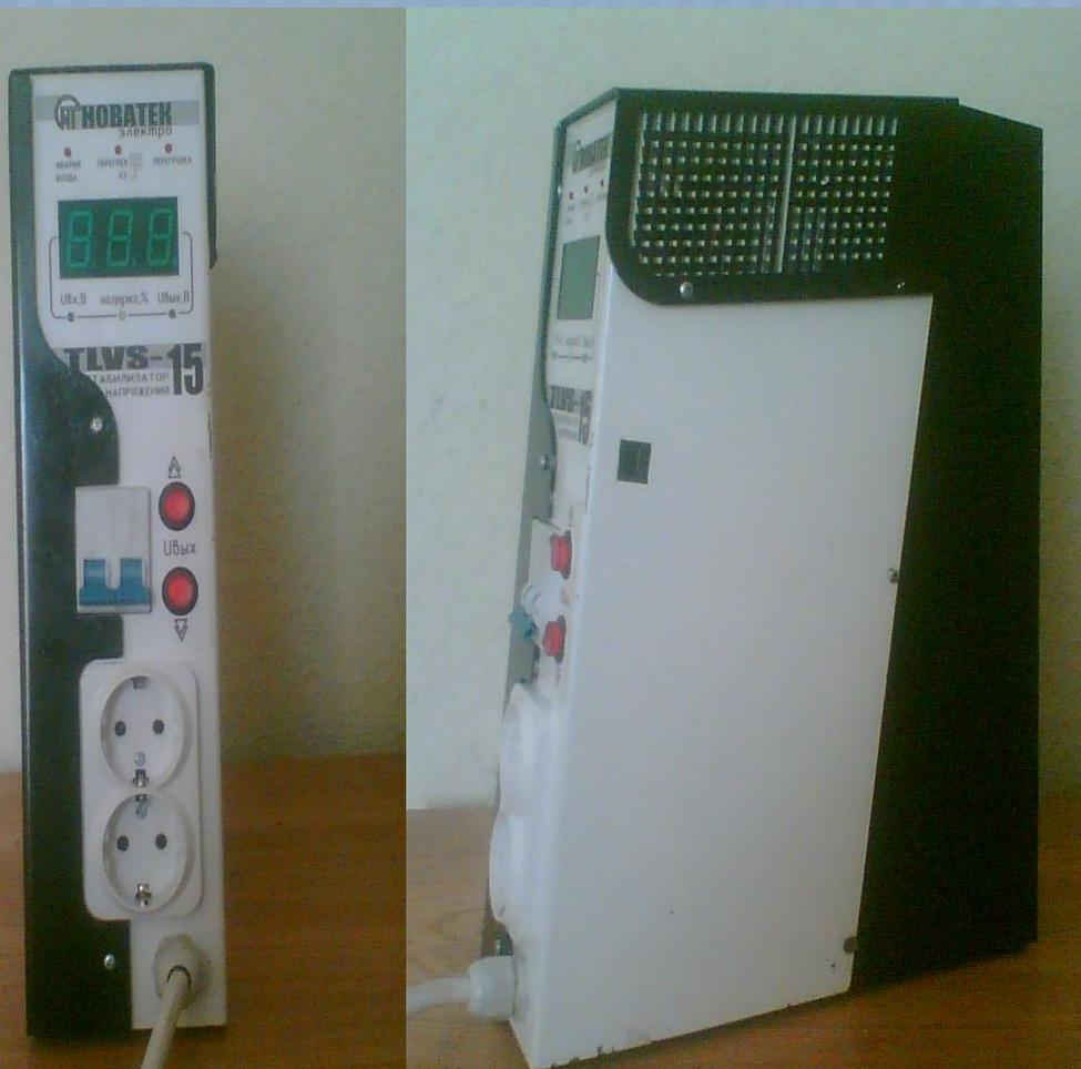
Прибор должен стабилизировать выходное напряжение от 170В до 240В с погрешностью 1 В, при входном напряжении от 150 В до 250 В. Стабилизируемая мощность 1500 Вт. Температура среды (помещение) от +5<sup>0</sup>С до +40<sup>0</sup>С
