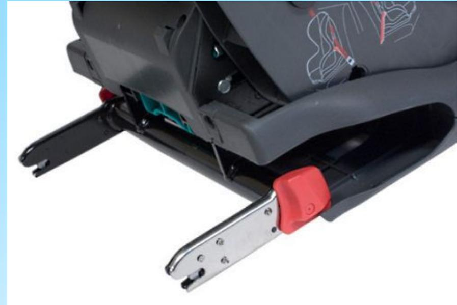
**ISOFIX** (International Standards Organisation FIX) – европейский стандарт для производителей автокресел, представляющий собой систему жесткого крепления кресла к кузову автомобиля. Система состоит из 2 металлических креплений с замком в основании автокресла, с помощью которых оно «защелкивается» на скобах, вмонтированных в кузов авто между сиденьем и спинкой автомобильного кресла. Обычно располагается на заднем диване, справа и слева
