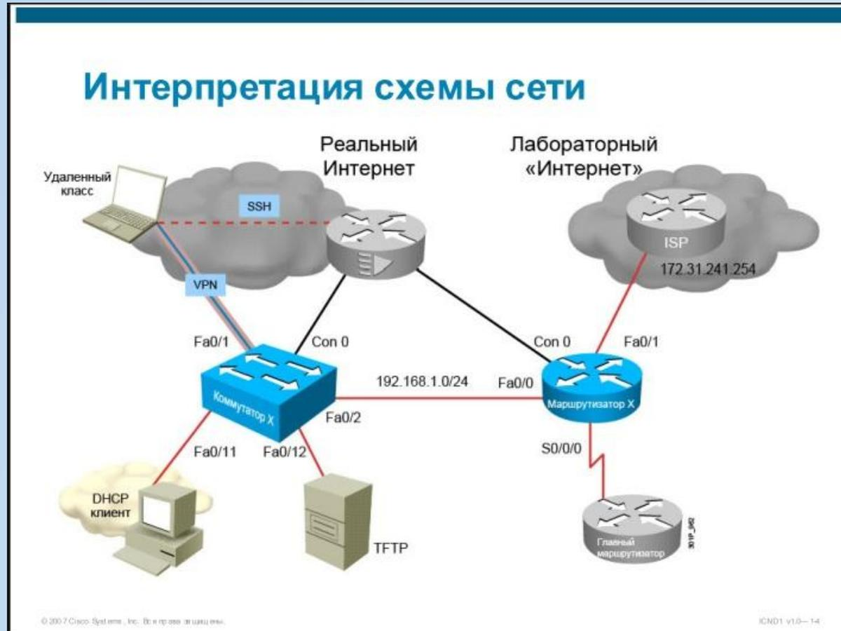
**Схема сети используется для отображения информации о ней. Объем и детализация отображаемой информации варьируются в зависимости от организации. Топология сети, как правило, представляется с помощью линий и значков. На этой схеме**
