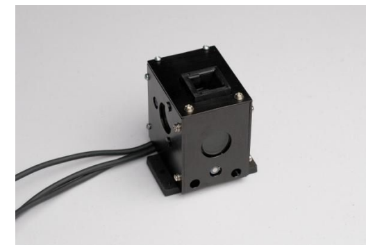
Приставка для автоматического переключения поляризации
