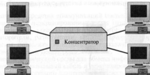
Рис. 9.2. Топология «звезда»
