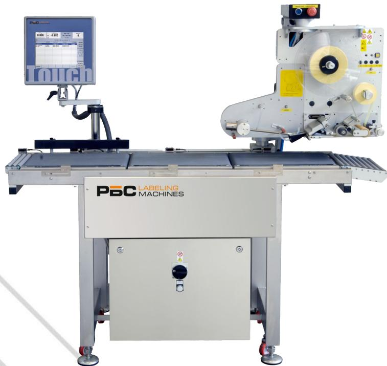
Автоматическая подача, взвешивание и транспортировка продукта, автоматическая печать и нанесение этикетки.
