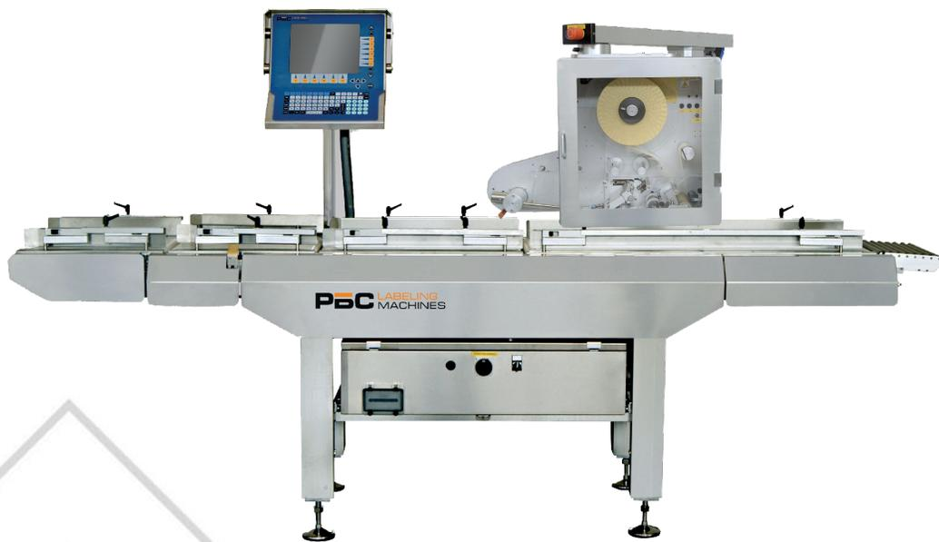
Автоматическая подача, взвешивание и транспортировка продукта, автоматическая печать и нанесение этикетки.
