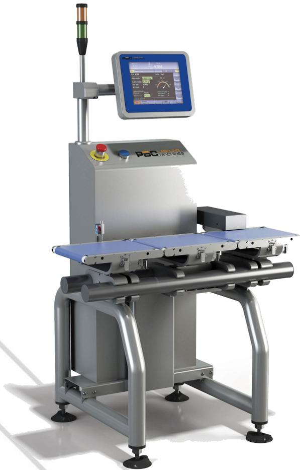
Система динамического взвешивания позволяет с высокой точностью и за кратчайшее время определять вес отдельных предметов или упаковок, движущихся по конвейеру.
