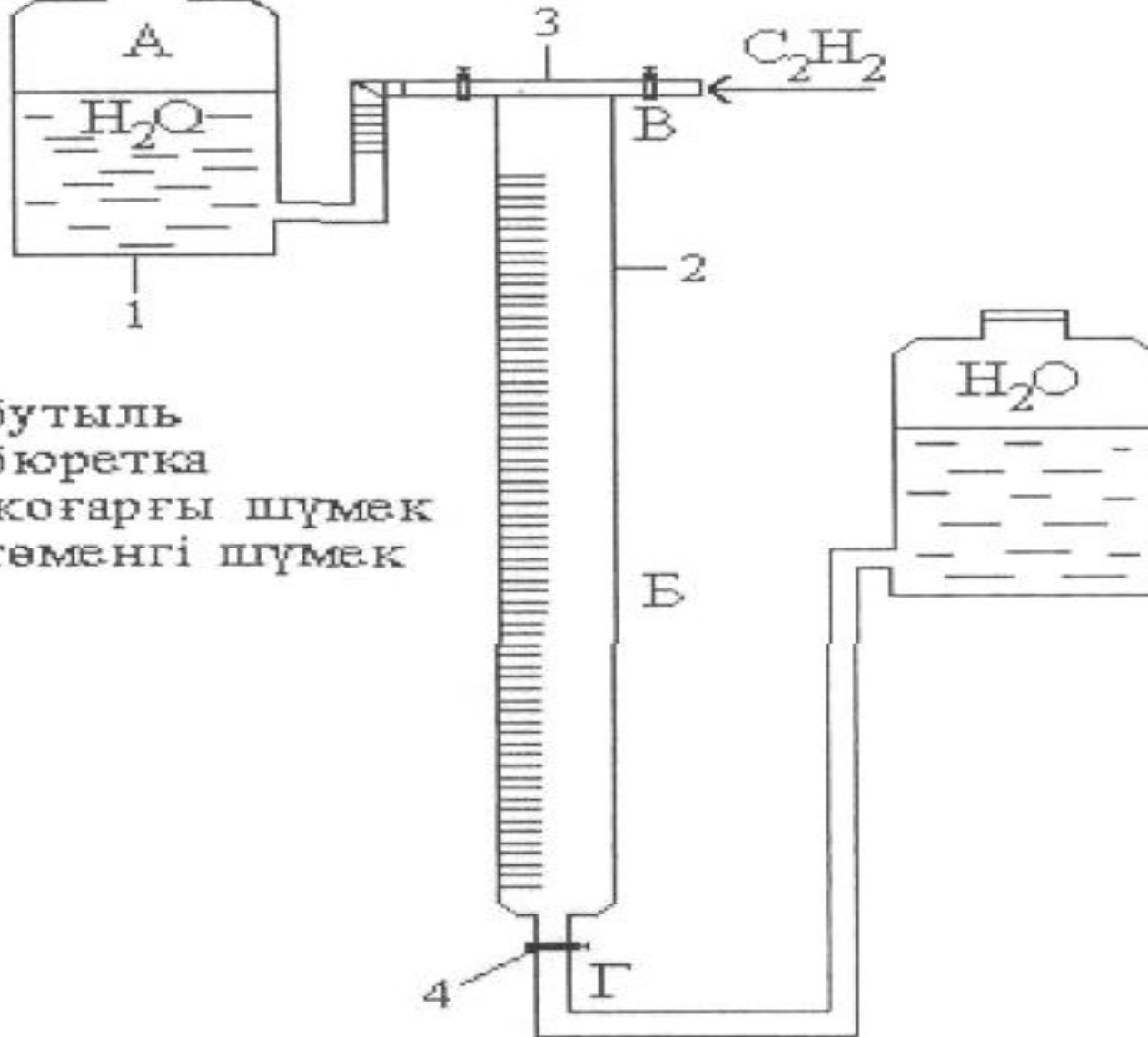
2-сурет - Ацетиленнің тазалығын тексеру Таза ацетиленді ас тұзының ерітіндісімен толтырылған газометрге жинайды
