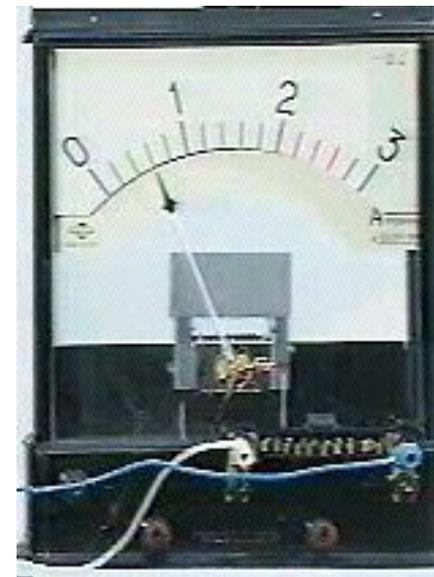
Шунт — устройство, которое позволяет электрическому току протекать в обход какого-либо участка схемы, обычно представляет собой резистор, катушку или проводник.
