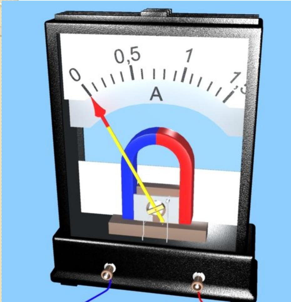
Измерительный механизм магнитоэлектрической системы, снабжён набором шкал и шунтов.
