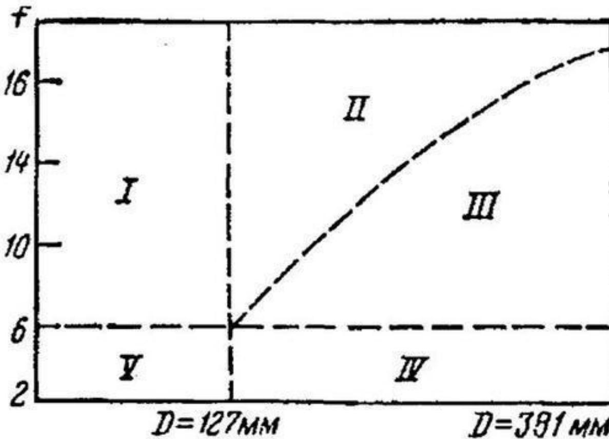
Области применения различных типов инструмента в зависимости от коэффициента крепости породы и диаметра долота:
