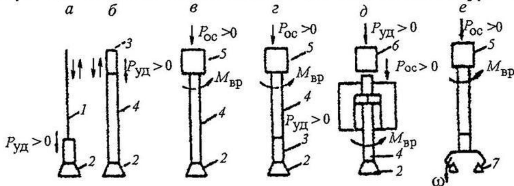
а – ударное; б – ударно-поворотное; в – вращательное (сплошное и колонковое); г – ударно-вращательное; д – вращательно-ударное; е – шарошечное бурение
