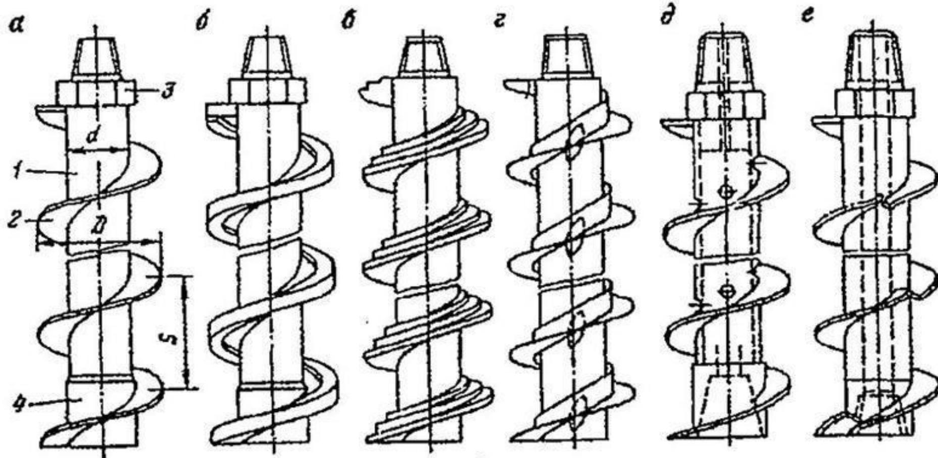
а — сплошной; б — полой коробчатой; в — полой уступчатой;
