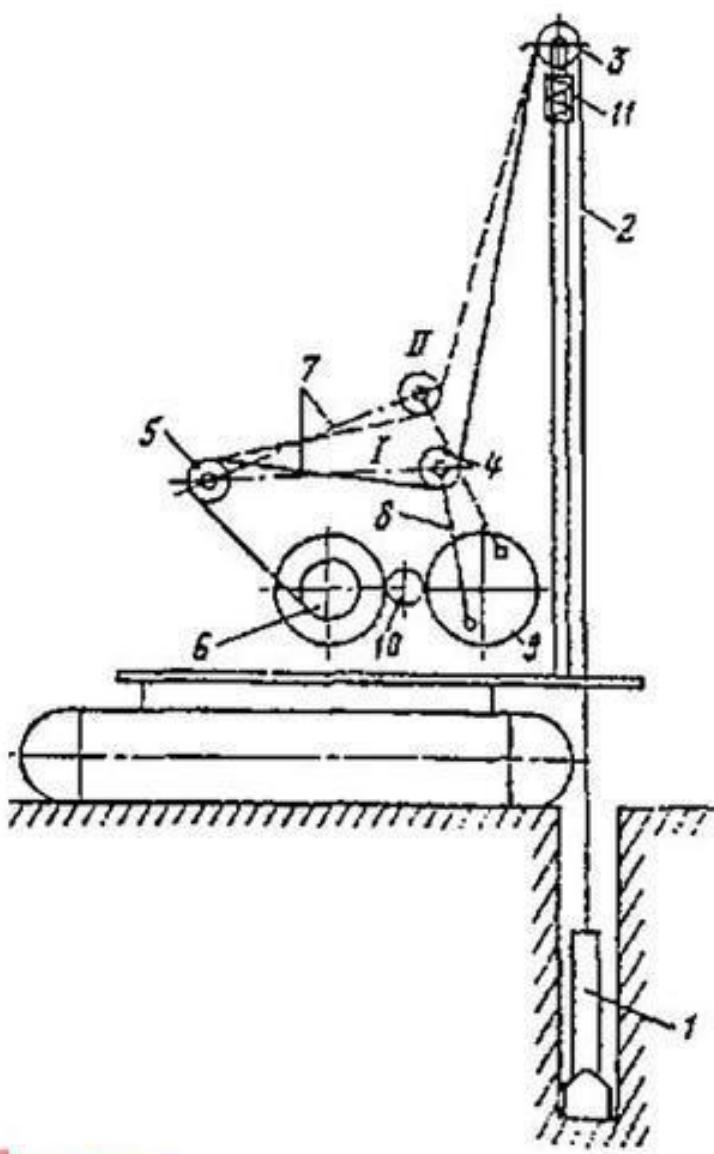
Станки ударно-канатного бурения предназначены для бурения вертикальных разведочных или дренажных скважин по породам любой крепости на глубину до 300 м.
