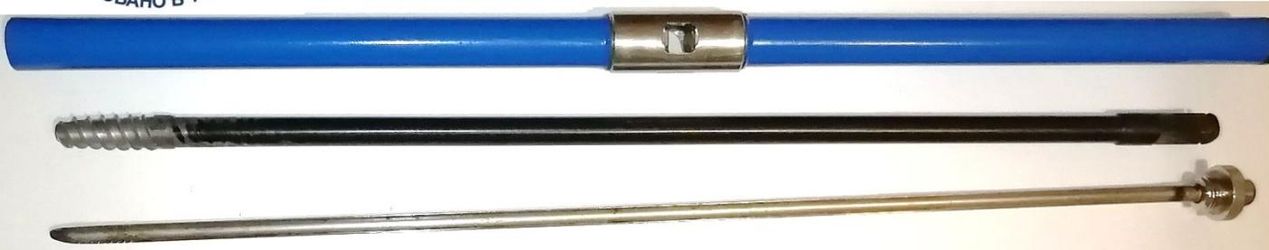
Бурав для высверливания образцов древесины - кернов
