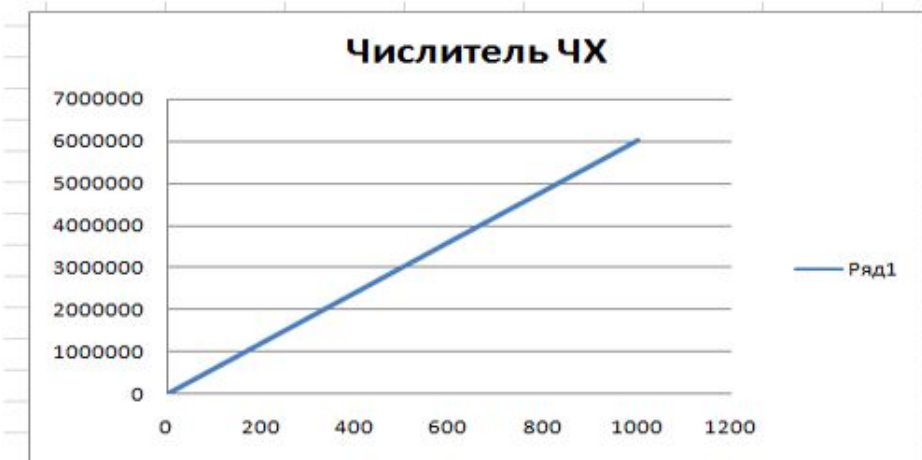
Рис. 11 Частотная передаточная функция числителя разомкнутой системы
