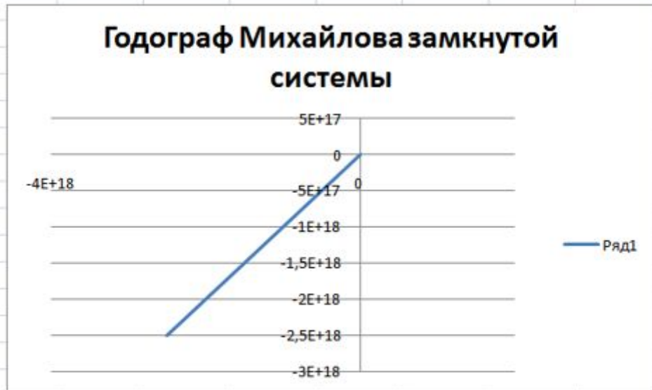
Рис.27 Годограф Михайлова замкнутой системы
