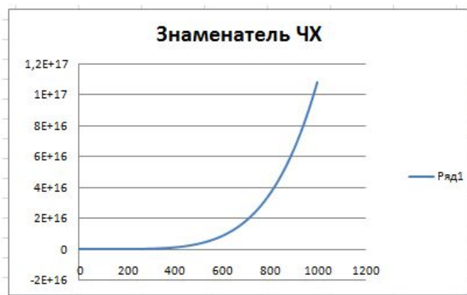
Рис.10 Частотная передаточная функция знаменателя разомкнутой системы
