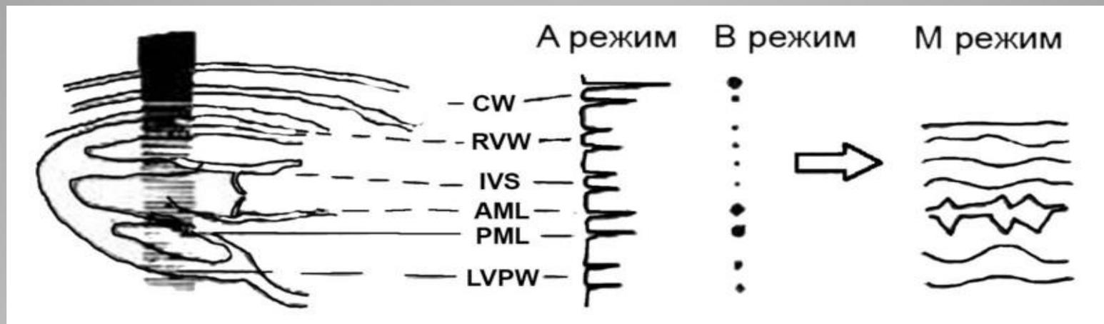
А-режим — амплитудный режим (интенсивность принятых эхо-сигналов представлена в виде электрических импульсов различной амплитуды)
