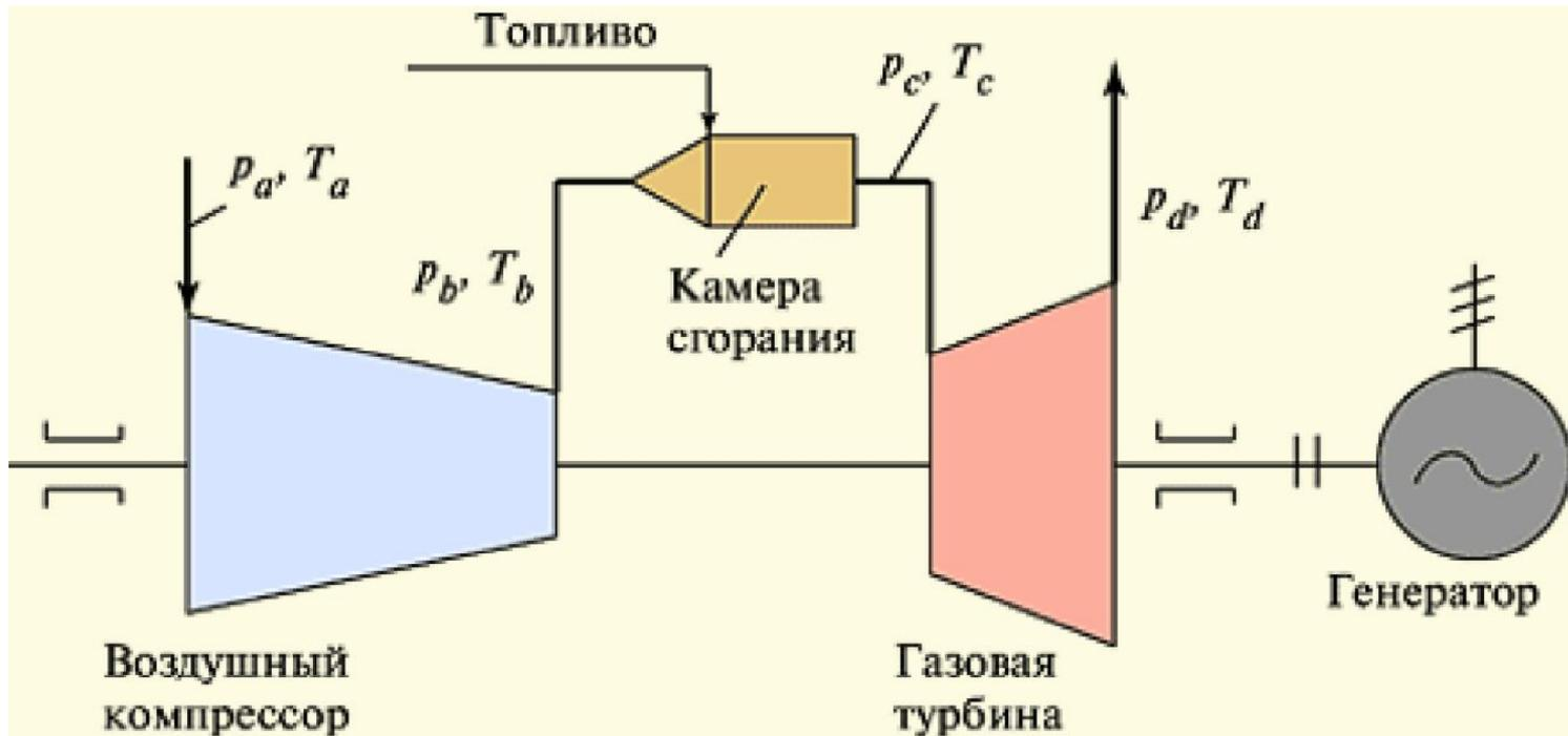
Рис. 7.2. Схема ГТУ простой схемы в условных обозначениях
