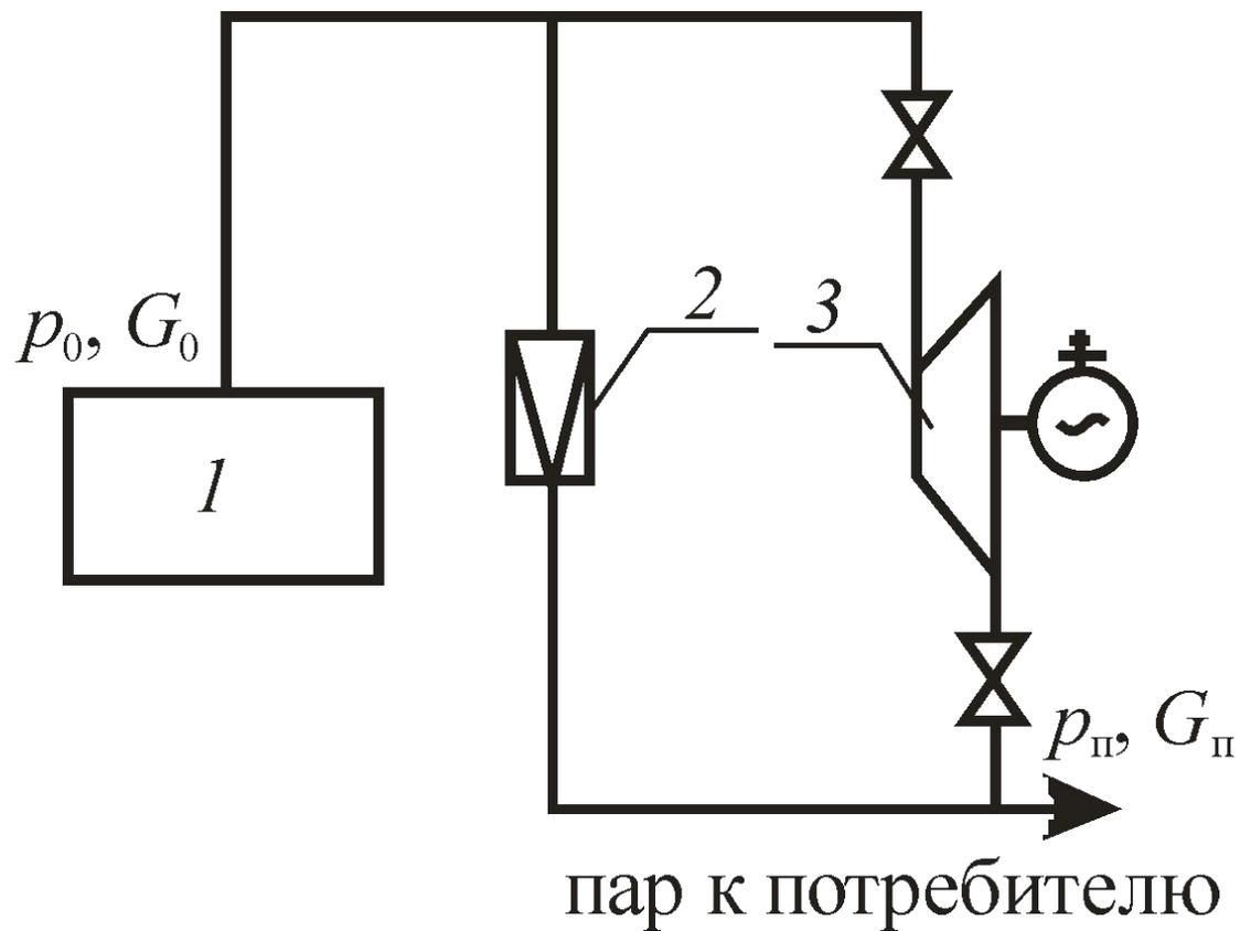
1 – паровой котел; 2 – редукционно-охладительная установка; 3 – турбина с противодавлением;
