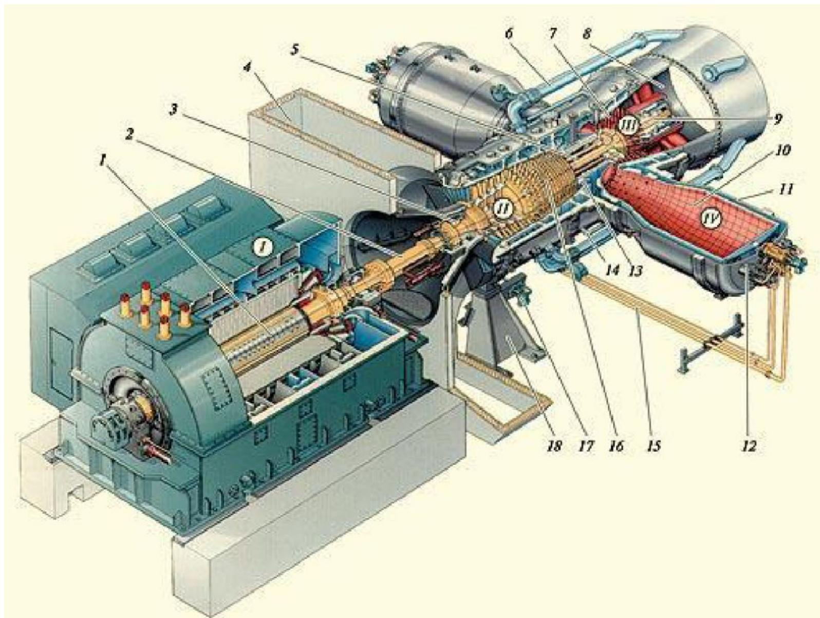
Рис. 7.4. Устройство ГТУ V94.3 (рисунок из проспекта фирмы Siemens)
