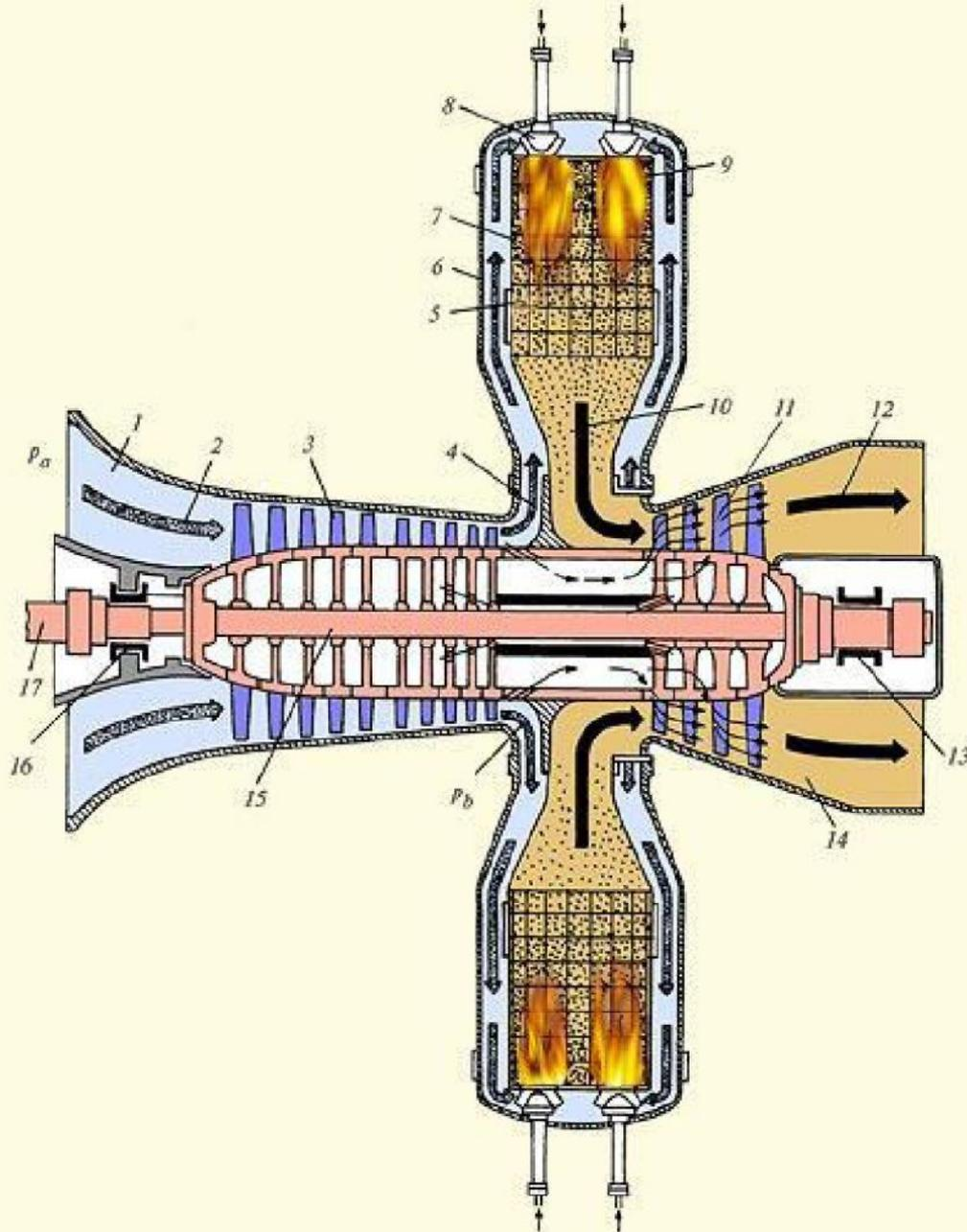
Рис. 7.1. Принципиальная схема ГТУ
