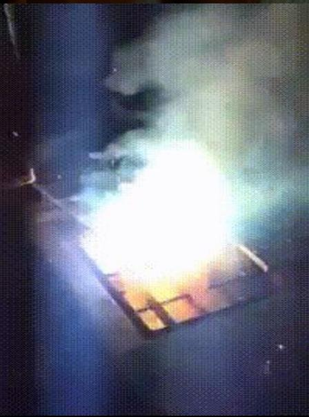
Электродуговая резка металла основана на расплавлении металла с удалением его из места реза за счет механического давления сварочной дуги и собственного веса расплавленного металла
