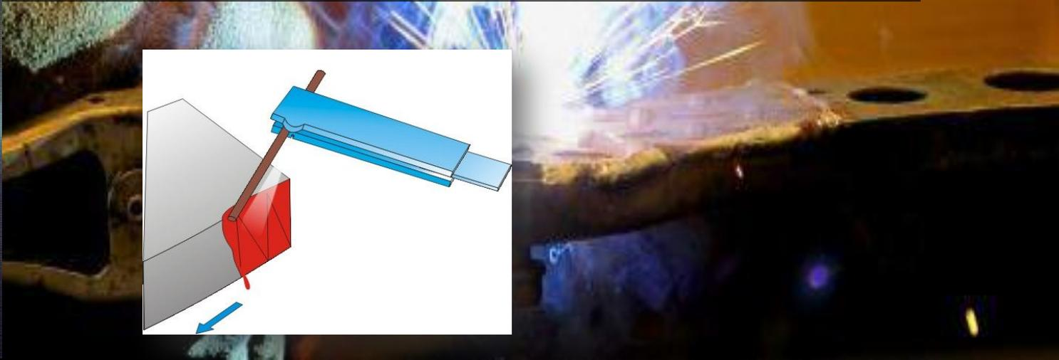
Указанными методами можно резать сталь, чугун и цветные металлы с использованием угольных или толстопокрытых металлических электродов. Резка угольными электродами производится только постоянным током при прямой полярности. Ток для резки угольным электродом подбирают в зависимости от теплофизических свойств и толщины разрезаемого металла.
