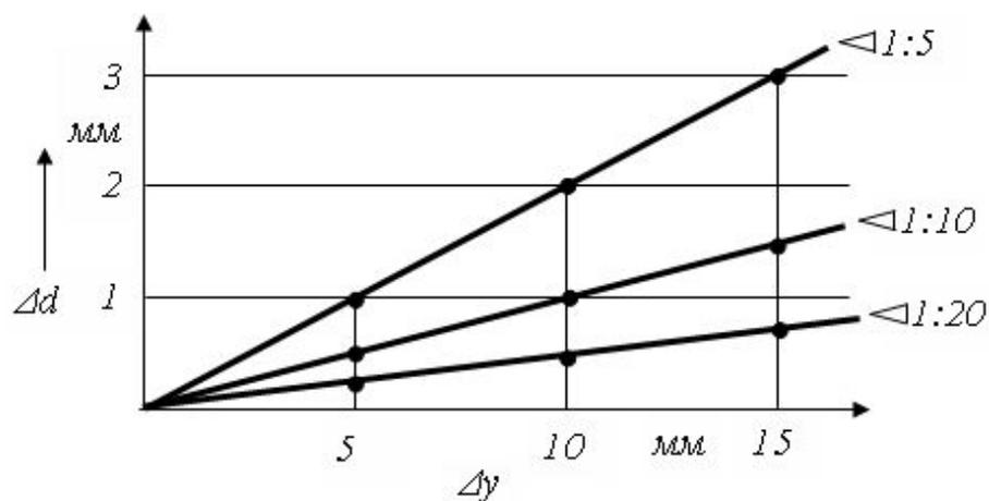
Положения полей зазоров «гребень колеса - рельс» для трех значений разности диаметров колес:  $\Delta d = 0; 0,5; 1,0 \text{ мм}$
