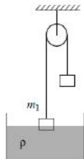
объём погруженной в жидкость части груза равен  $V = 1,5 \cdot 10^{-4}$  м<sup>3</sup>. Определите ускорение  $a$  первого груза. Обоснуйте применимость использующихся законов к решению задачи.
