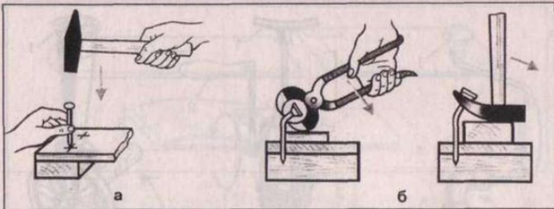
Рис. 32. Забивание (а) и выгаскивание (б) гвоздей
