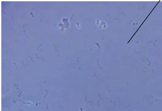
Вращая маховичок держателя, перемещать микроскоп в сторону объектива до получения резкого изображения пылинок или царапин на поверхности последней линзы объектива (можно нанести на поверхность немного мела). Снять отсчёт  $a_1$  по шкале объективодержателя и занести его в таблицу 3 протокола.
