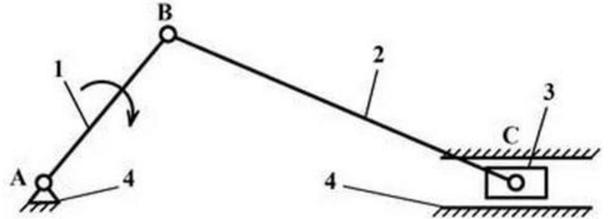
Рис. 2.5.2 Кривошипно-ползунный механизм
