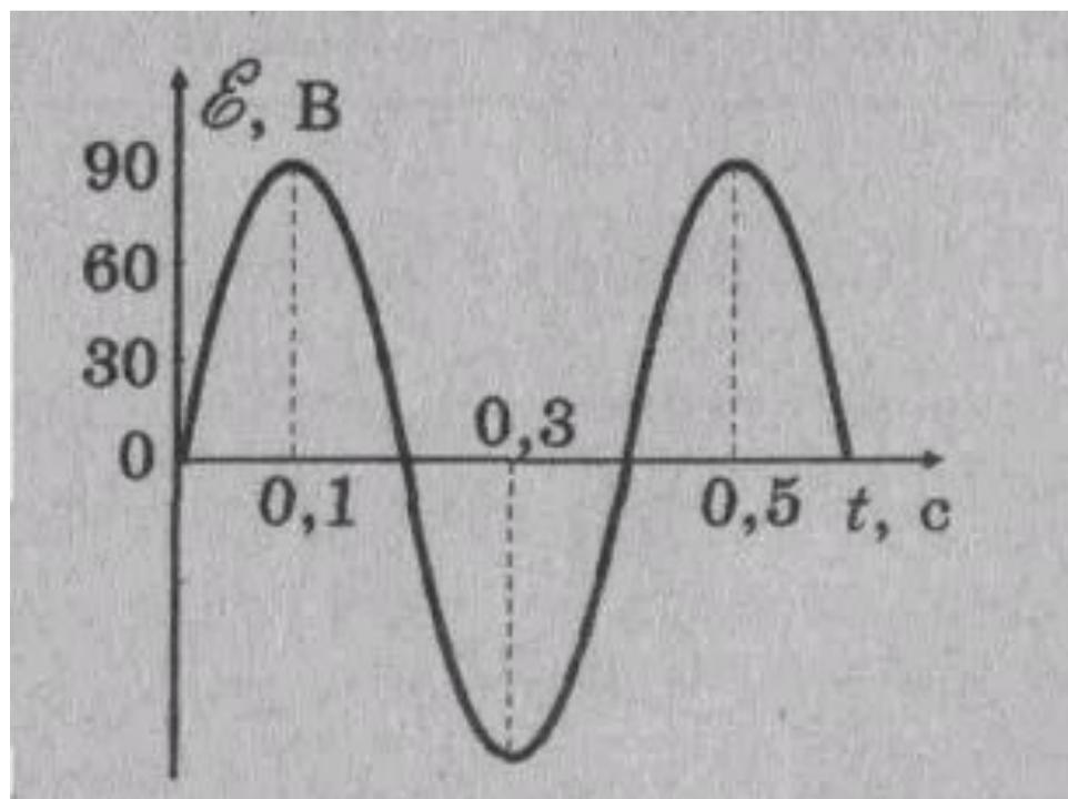
4. По графику, изображенному на рисунке, определите амплитуду напряжения и период колебания. Запишите уравнение мгновенного значения напряжения.
