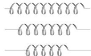
Модель 3.61. Исследование зависимости сопротивления проводника от его длины
