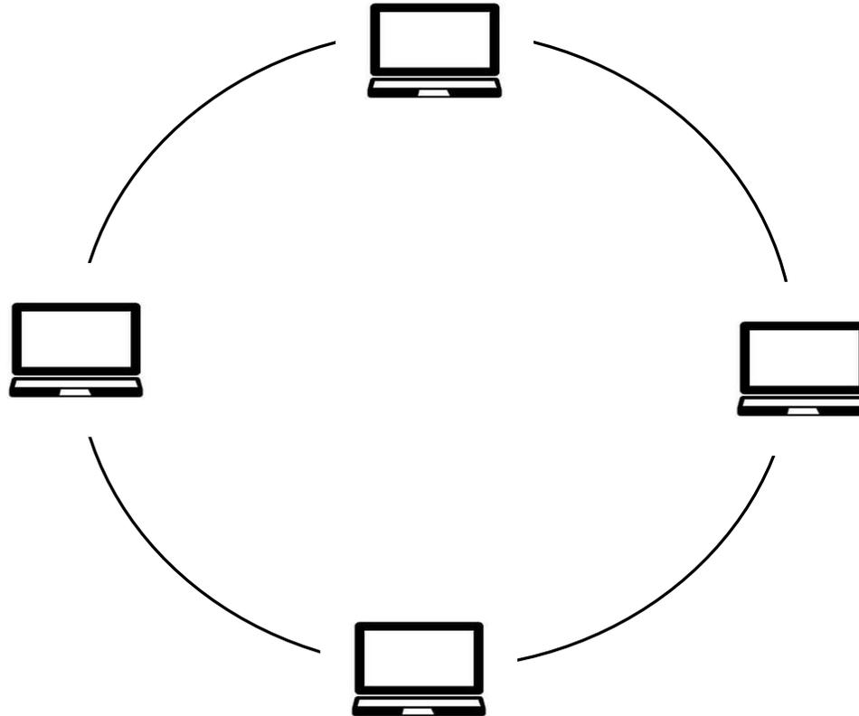
*При кільцеобразной топологии каждая рабочая станция соединяется с двумя своими ближайшими соседями . Такая взаимосвязь образует локальную сеть в виде петли или кольца. Данные передаются по кругу в одном направлении, а каждая станция играет роль повторителя, который принимает и отвечает на пакеты, адресованные ему, и передает другие пакеты следующей рабочей станции «вниз».*
