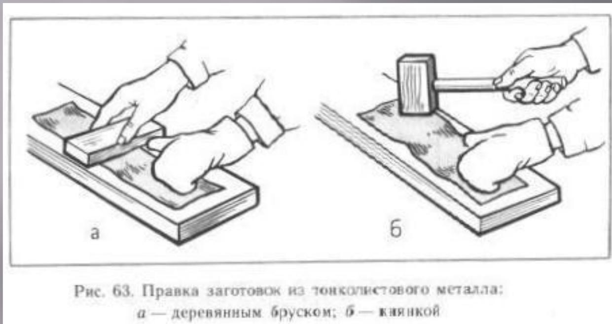
Рис. 63. Правка заготовок из тонколистового металла:
