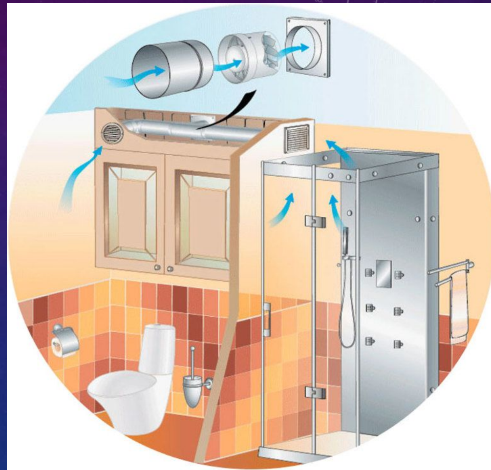
Устройство выбросного устройства вытяжной вентиляции
