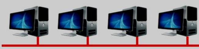
Используется один кабель вдоль которого подключены все компьютеры сети. Терминатор необходим для поглощения передаваемого сигнала на концах.
