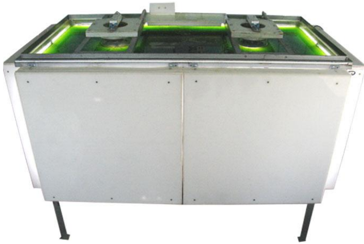
Полостной гладкостенный фотобиореактор с механическим перемешиванием (ФБР)
