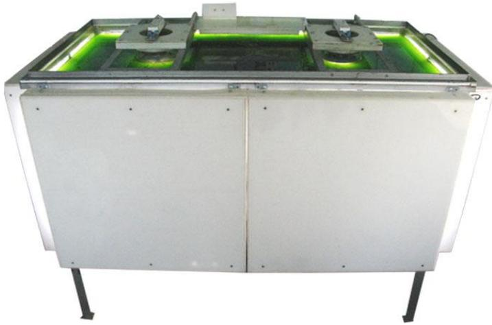
Полостной гладкостенный фотобиореактор с механическим перемешиванием (ФБР)
