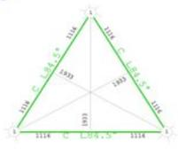
Балки каркаса купола
