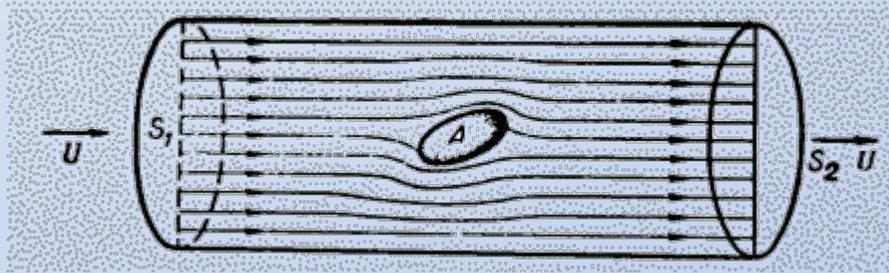
Возьмём длинную прямую трубку, по которой течет невязкая жидкость с постоянной скоростью  $U$ , и поместим в середину трубки препятствие  $A$  ( $S_1$  и  $S_2$  - поперечные сечения). По теореме Эйлера, результирующая всех давлений на жидкость равняется сумме
