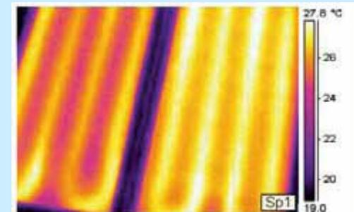
Образец 1 – «мокрый» способ      Образец 2 – «сухой» способ
