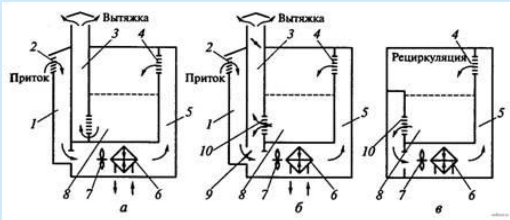
Схемы систем воздушного отопления: а - прямоточная; б - с частичной рециркуляцией; в - с полной рециркуляцией; 1 - воздухозаборная шахта; 2, 4, 10 - решетки; 3 - выбросная шахта; 5 - приточный воздуховод; 6 - калорифер; 7 - вентилятор; 8 - рабочая зона; 9 – клапан
