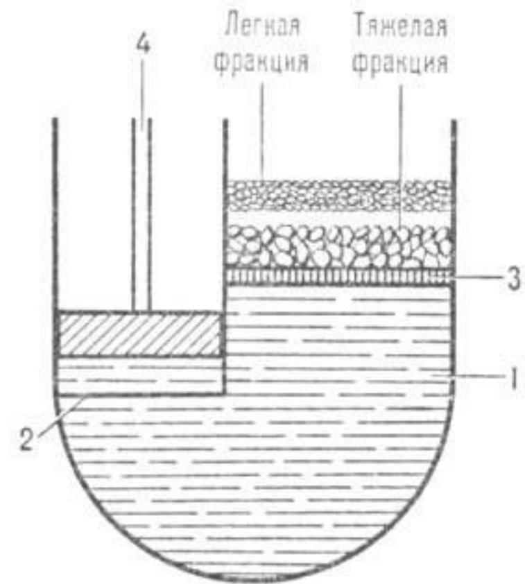
Гидравлическая отсадочная машина:
