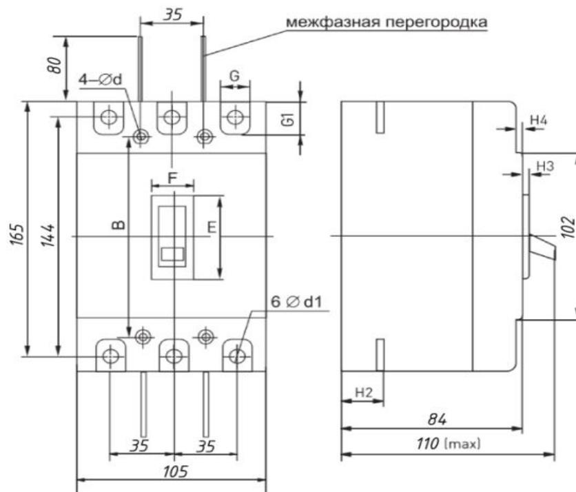
Автоматический выключатель ВА-99МЛ 250/200А 3Р 20кА поставим для защиты по входу преобразователя частоты от коротких замыканий,
