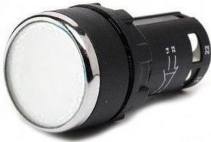
Через кнопку без фиксации MB101DB 2xOFF-(ON) (0.3A/240VAC) будет происходить включение магнитного пускателя на пульте управления оператора от 220 В.
