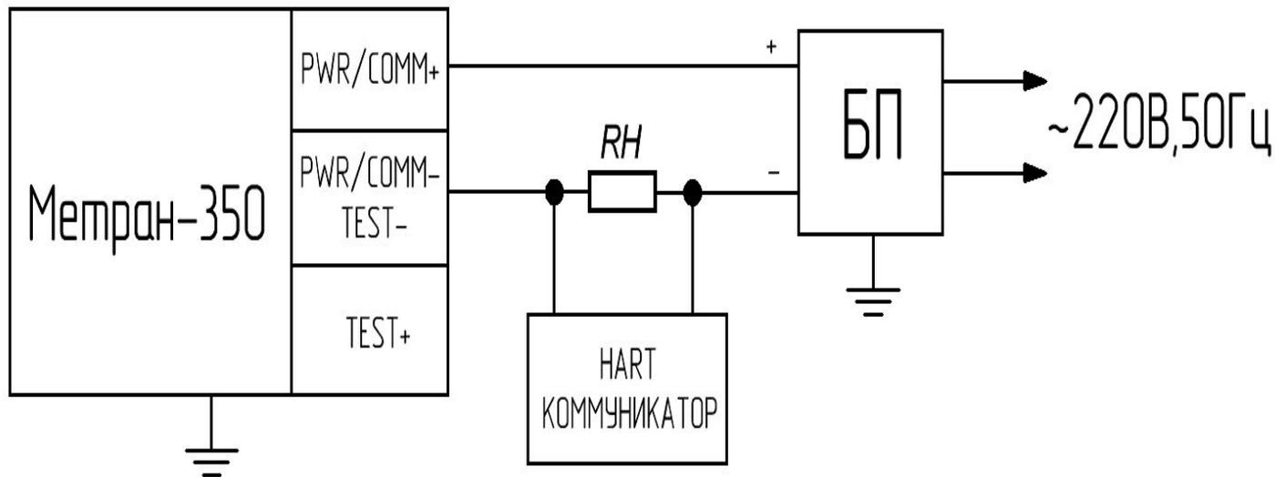
Схема подключения датчика расхода газа
