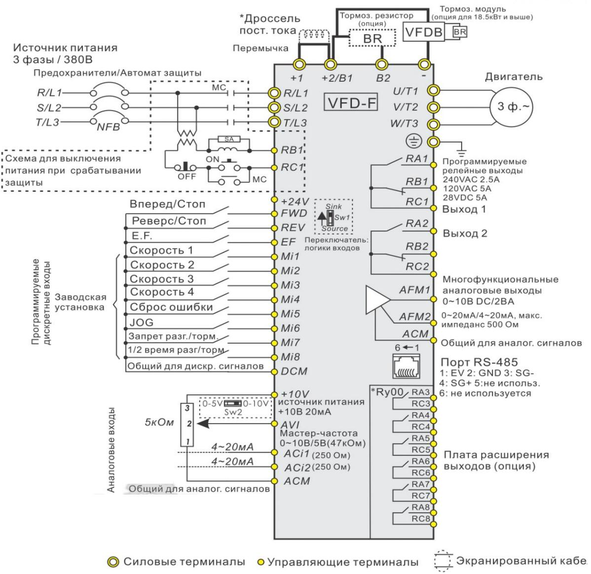
Схема подключения ПЧИ VFD-F Series
