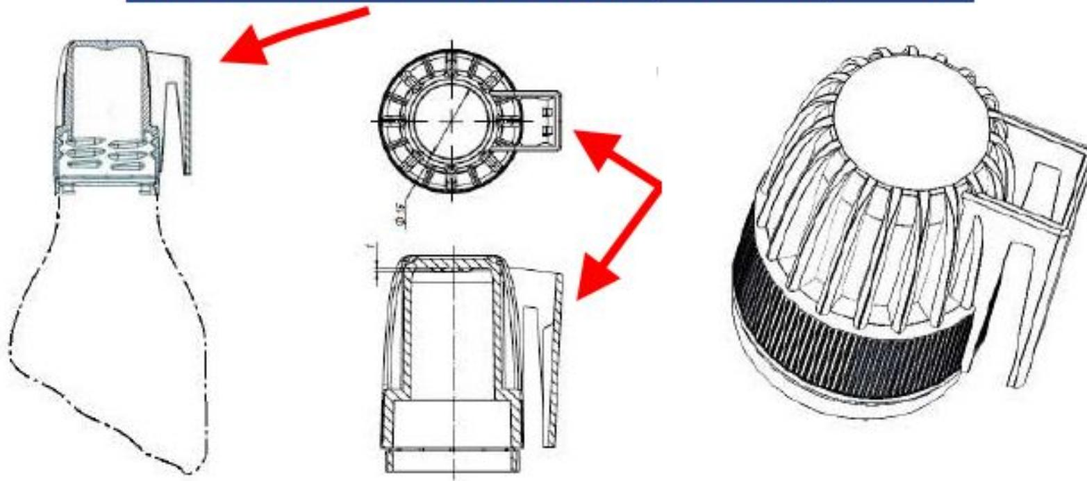
Изделие компактно и не выходит за габариты бутыли. Имеет наименьший вес по сравнению с конкурентами. Устройства зацепа позволяет подвешивать бутыль за любые элементы одежды, а так же быстро отцеплять бутыль. Имеется возможность быстрой подвязки бутыли через отверстие в крючке. Не препятствует откручиванию.
