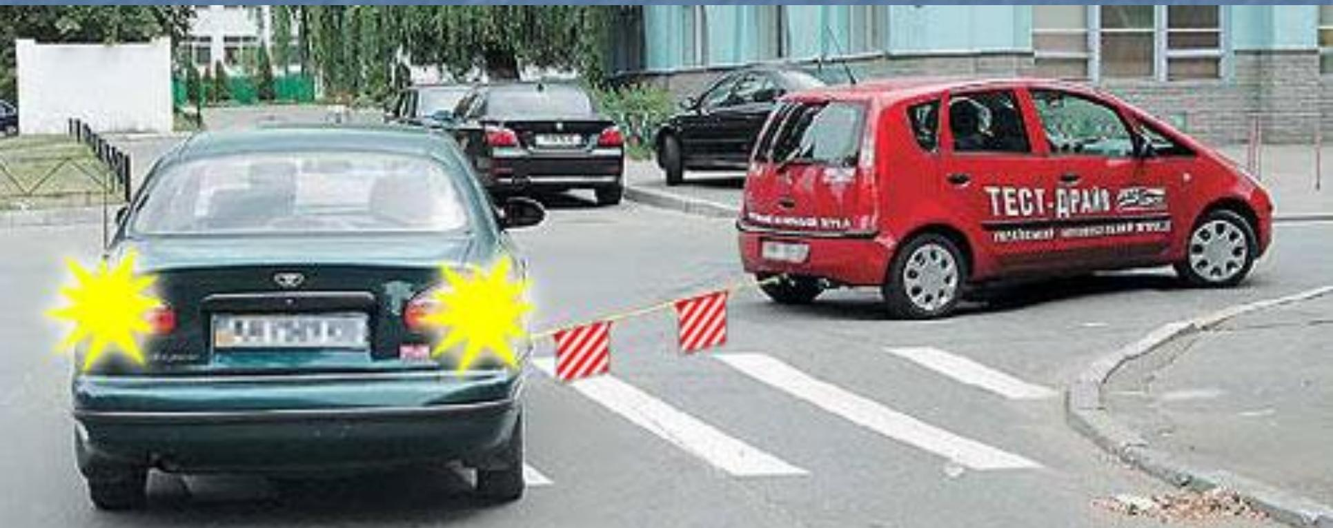
**Правила. Раздел 7. Пункт 7.3. При отсутствии или неисправности аварийной световой сигнализации на буксируемом механическом транспортном средстве на его задней части должен быть закреплён знак аварийной остановки.**
