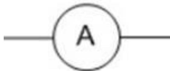
Обозначение амперметра на электрической схеме
