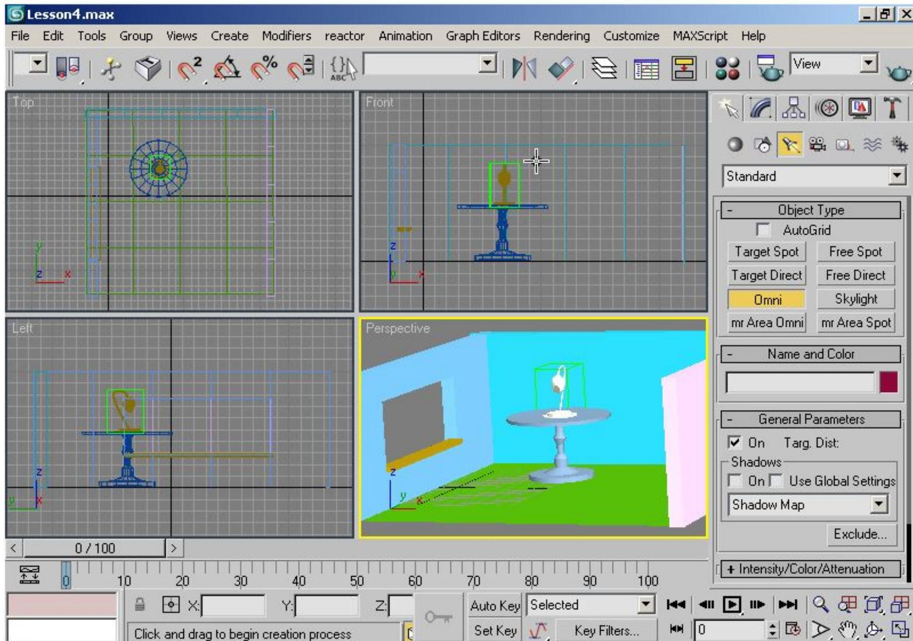
Источник «Omni» похож на лампочку, которая светит во все стороны. Для создания направленного источника, освещающего сцену параллельными лучами света, нажмите кнопку «Target Direct» («Направленный с мишенью»).
