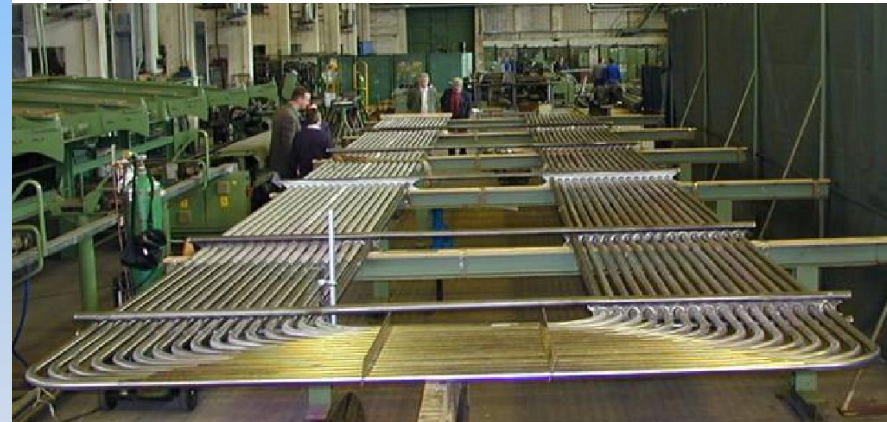
Испытательная часть перегревательных поверхностей котла башенного типа для электростанции Вейсвеллер
