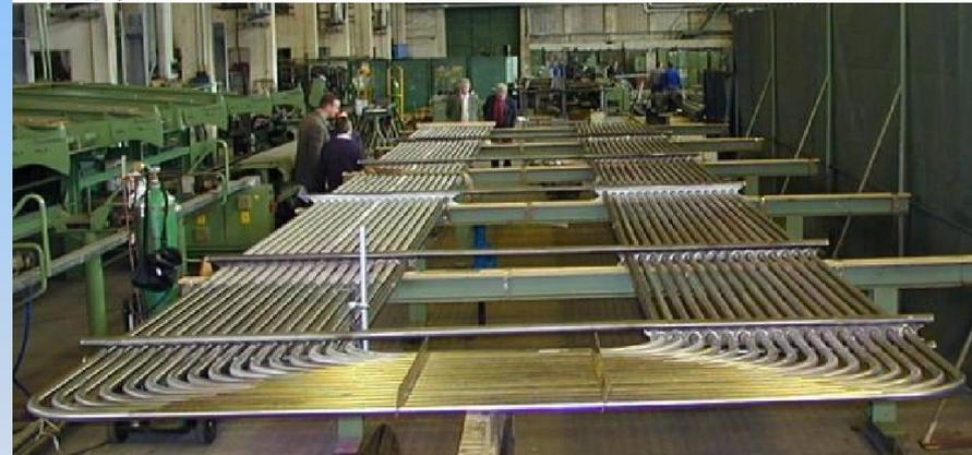
Испытательная часть перегревателей поверхностей котла башенного типа для электростанции Вейсвеллер
