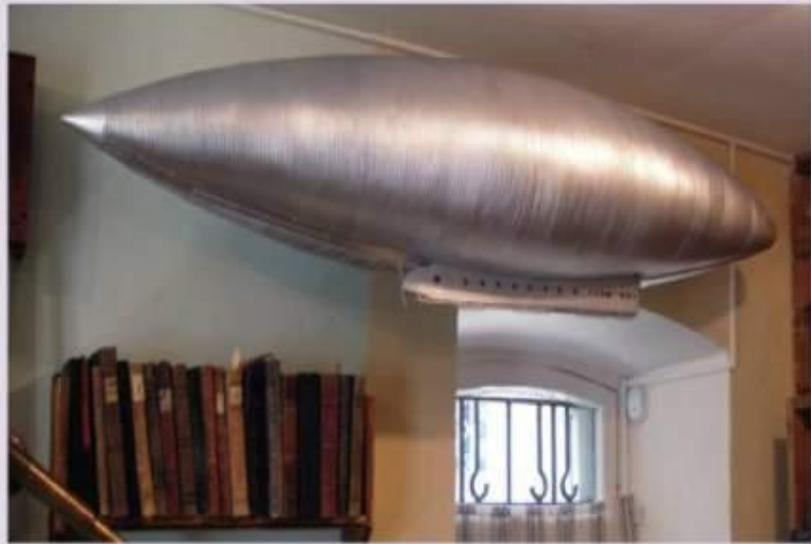
Циолковский разработал аэростат собственной конструкции. Это была новая и оригинальная конструкция дирижабля с тонкой металлической оболочкой.
